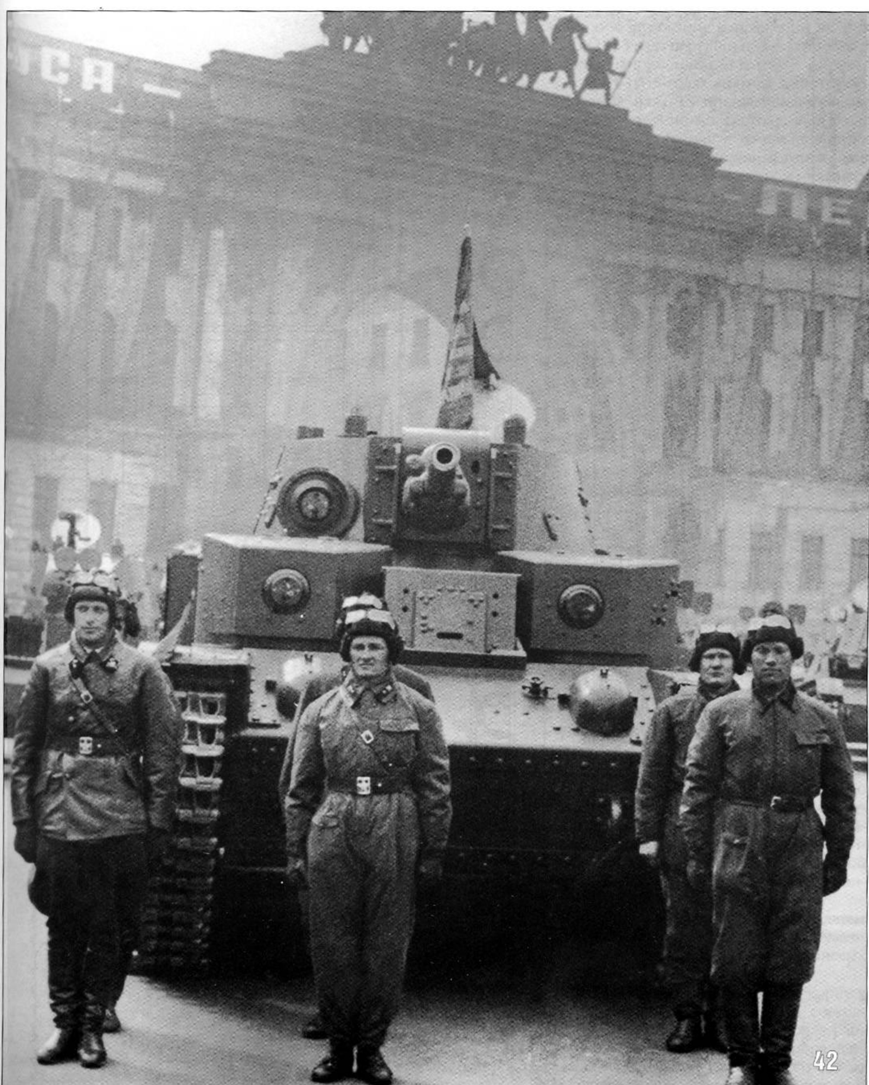
42. Единственное на сегодняшний день хорошее фото Т-28 с конической башней: танки перед парадом на площади Урицкого. Ленинград, 7 ноября 1940 года. Хорошо видно, что машина вооружена пушкой Л-10 (АСКМ).
