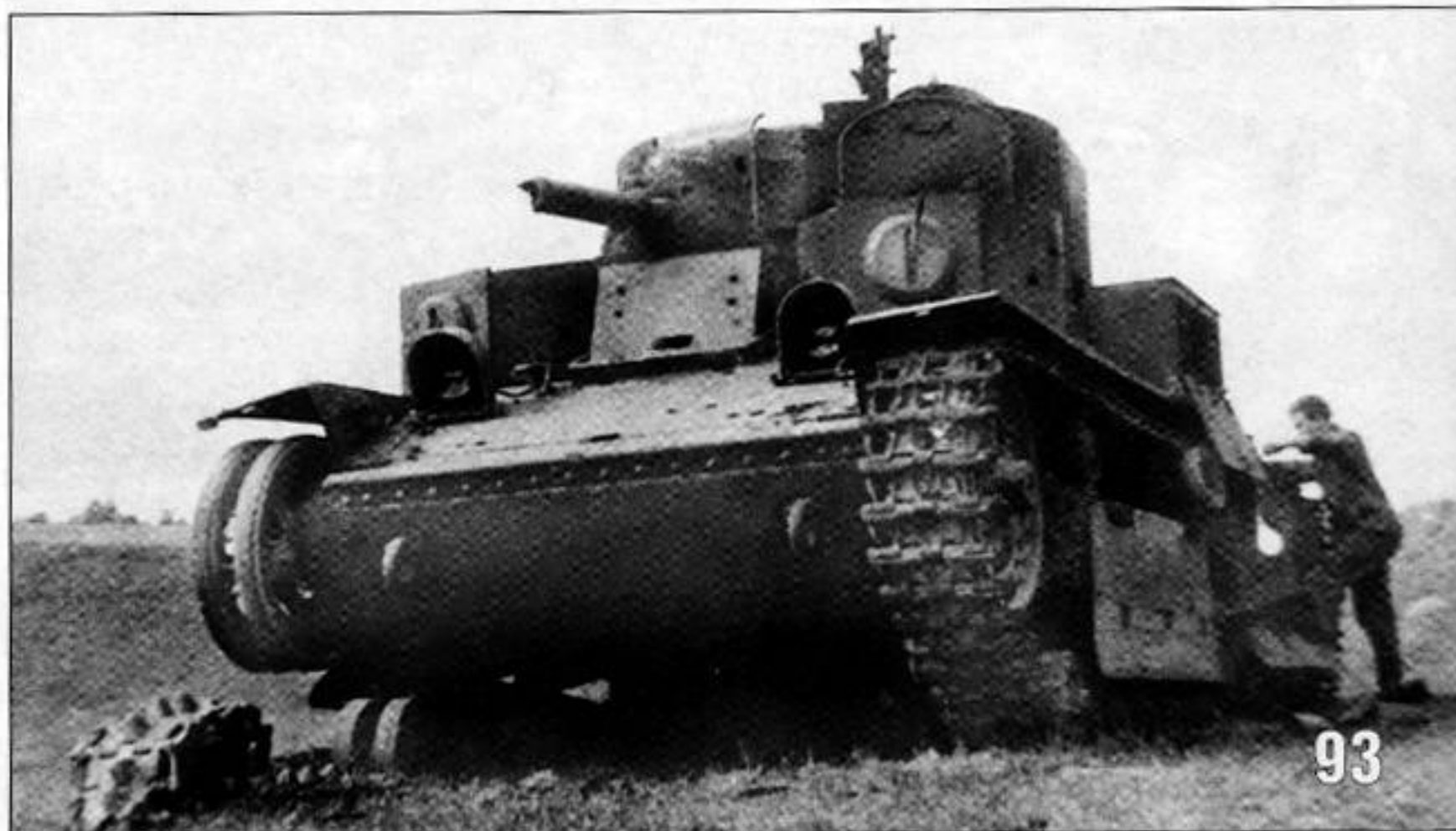
93, 94. Экранированный танк Т-28, подбитый немецкой артиллерией. Район Красногвардейска, август 1941 года. На фото 8-21 видно как минимум пять попаданий в танк 37 — 50 мм бронебойными снарядами, но нет ни одной пробоины (АСКМ).
