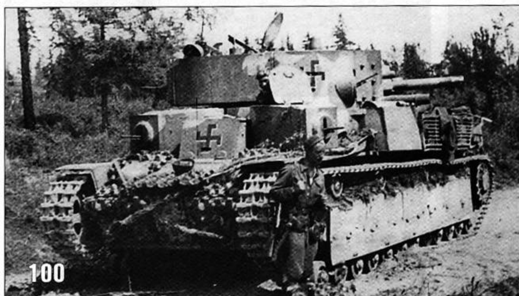
100. Экранированный Т-28, захваченный в сентябре 1941 года, на финской службе. Район Петровка, июнь 1944 года. Танк имеет трехцветный камуфляж, черно-белые финские свастики. Броневая защита маски пушки установлена финнами (Esa Muikku).
