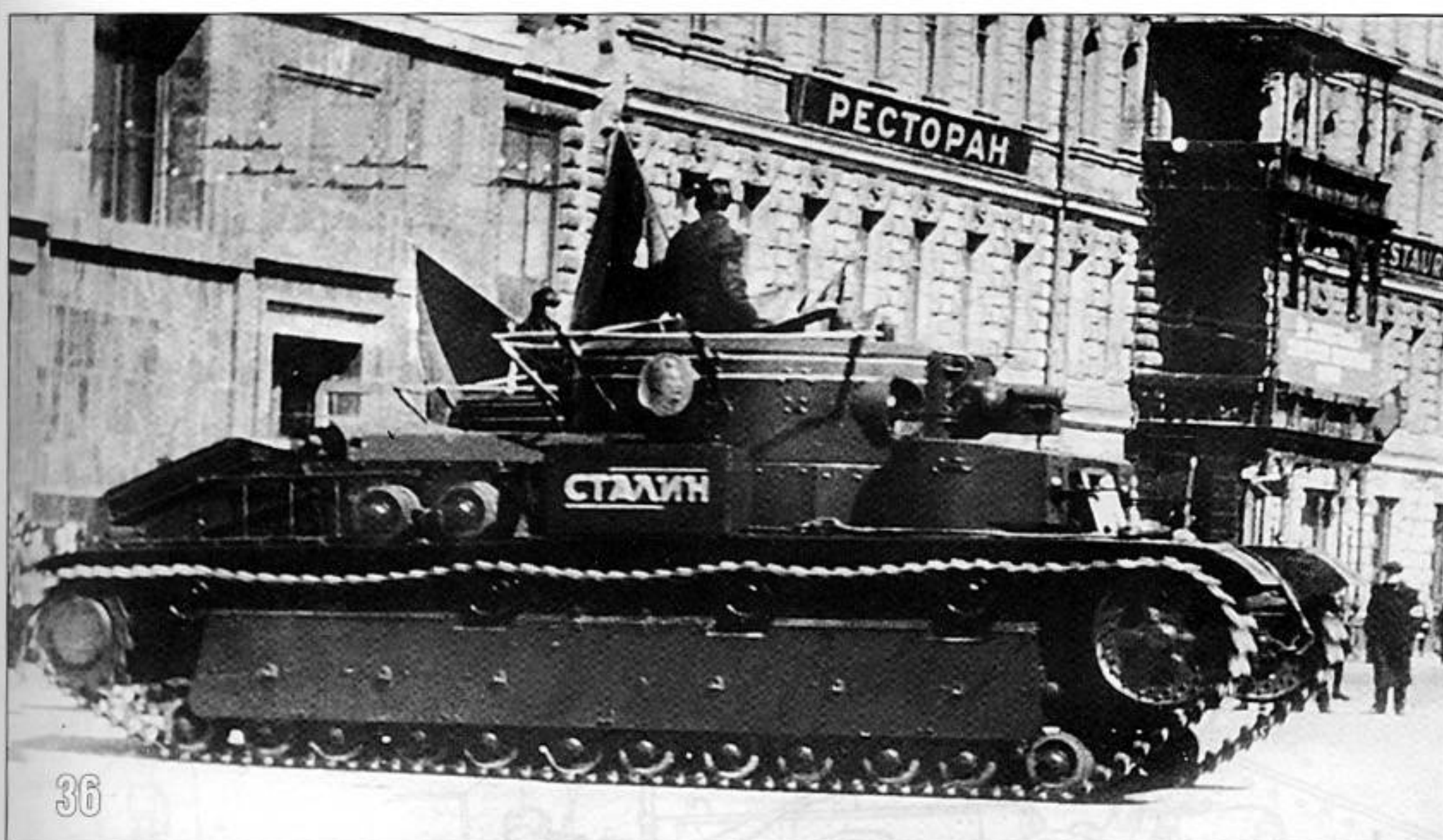
36. Именной танк «Сталин» направляется на Красную площадь. Москва, 7 ноября 1938 года. Танк выпуска 1938 года, помимо ЗИП на правом борту уложена лестница для залезания на танк (АСКМ).
