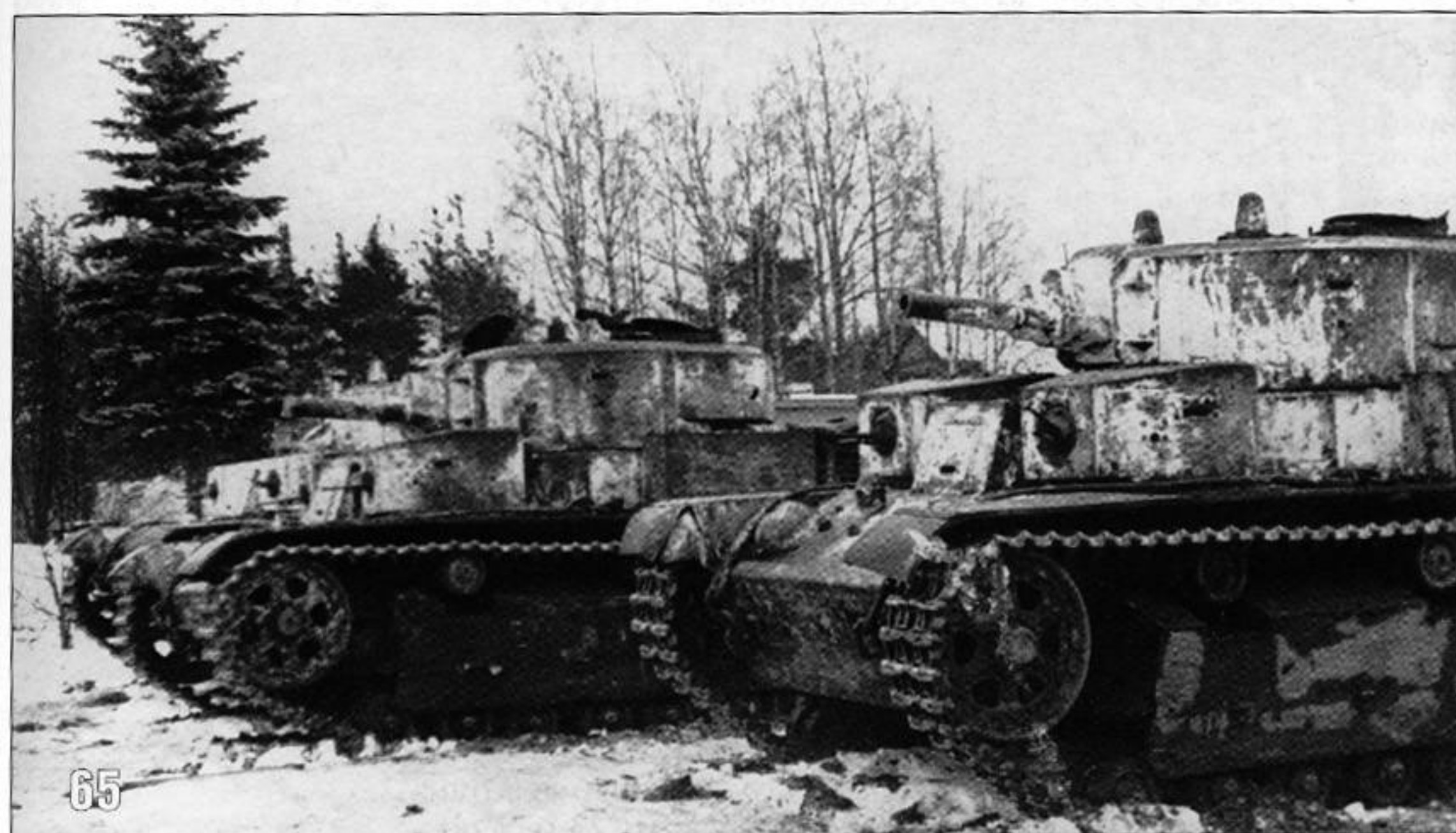
65. Танки перед выходом на боевую операцию. Карельский перешеек, февраль 1940 года. Передний танк выпуска конца 1939 — 1940 года с улучшенной бронировкой перископов наблюдения и ящиком для приборов дымопуска с наклонными бортами, задний танк выпуска первой половины 1939 года (РГАКФД).
