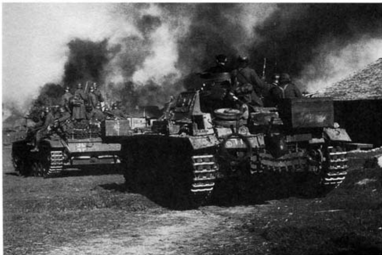
Танки Pz.III с десантом на броне в атаке. Октябрь 1941 года, район Спасс-Деменска. На корме танков закреплены большие ящики для ЗИП и инструмента.
