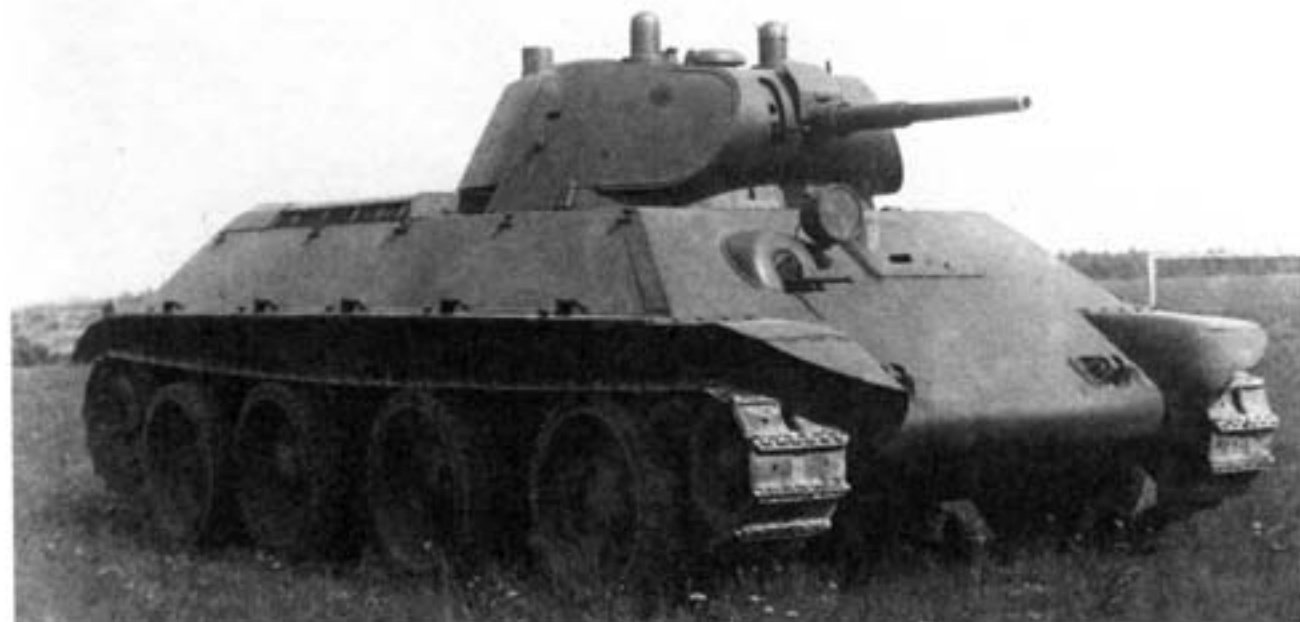
«Дедушка» знаменитой тридцатьчетверки – опытный колесно-гусеничный танк А-20, общий вид. Эта машина участвовала в боях под Москвой осенью 1941 года.
