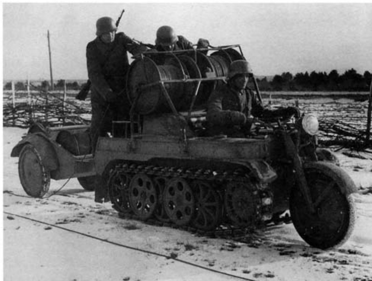
Укладка кабеля при помощи полугусеничного тягача NSU. Группа армий «Центр», ноябрь 1941 года.
