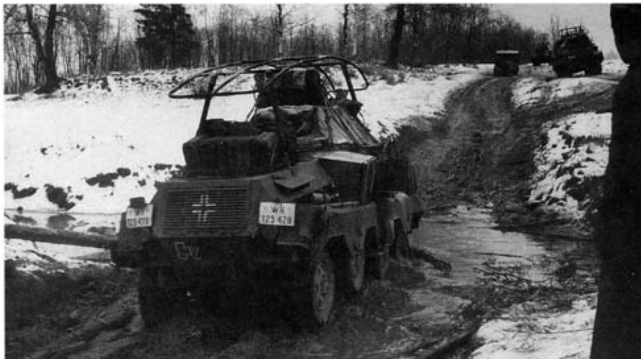
Бронеавтомобиль Sd.Kfz. 232 из состава 2-й танковой группы на проселочной дороге в районе Мценска. Октябрь 1941 года. Машина оснащена массивной рамочной антенной.
