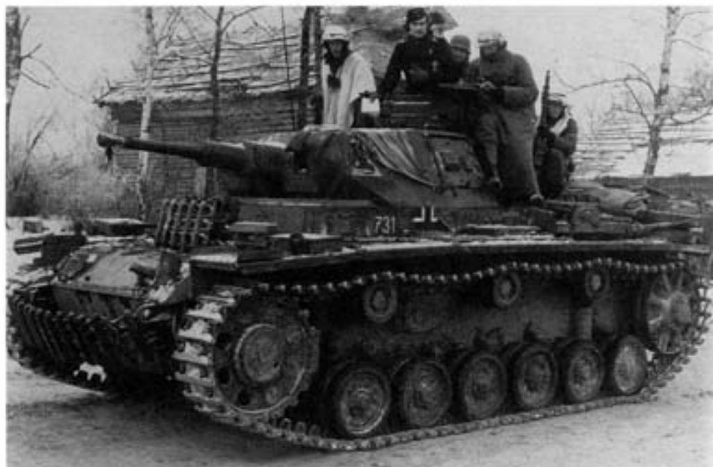
Танк Pz. III Ausf. H в пехотой на броне в районе Солнечногорска. Ноябрь 1941 года. Машина имеет тактический номер 731 и судя по эмблеме на башне принадлежит 2-й танковой дивизии вермахта. На лобовом листе корпуса установлена «дополнительная броня» – запасные траки.
