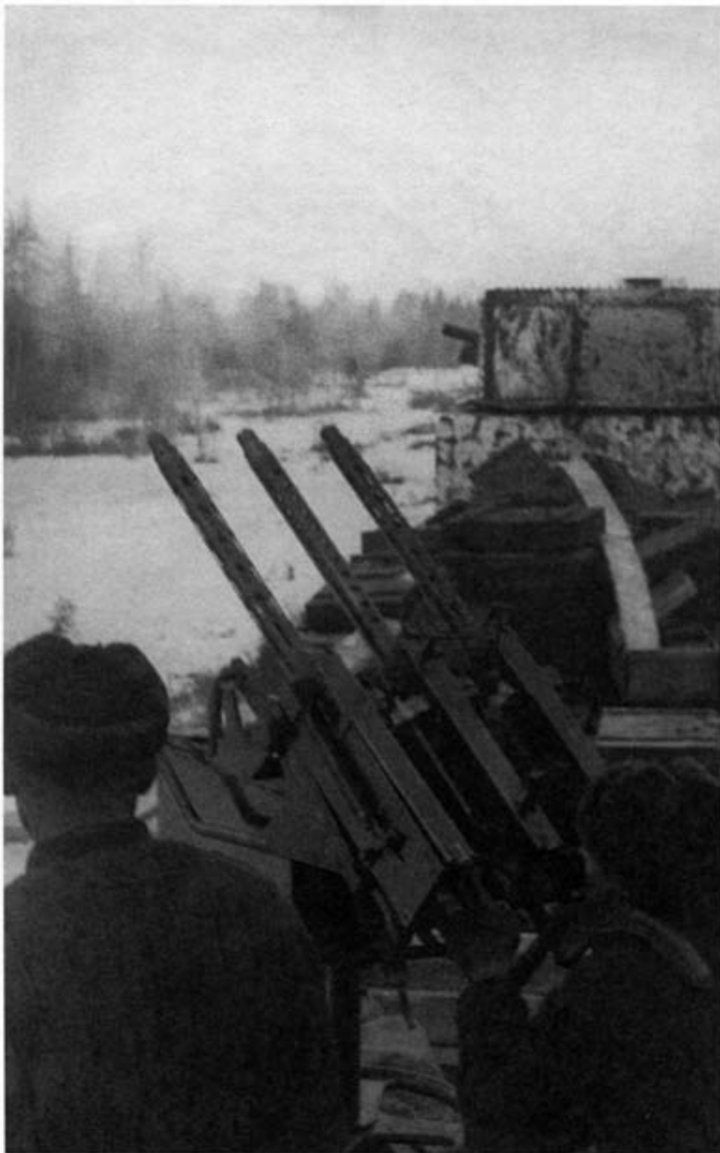
Зенитчики бронепоезда А. Булавина из состава 22-го ОДБП ведут огонь по самолетам противника из строенного 7,62-мм авиационного пулемета ПВ-1. Западный фронт, ноябрь 1941 года
