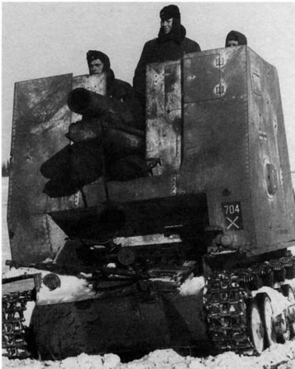
Самоходная установка SiG 33 (150-мм гаубица SiG 33 на шасси танка Pz.I Ausf.B) на огневой позиции. Ноябрь 1941 года. На переднем броневом листе видна эмблема 5-й танковой дивизии вермахта и тактический номер 704.
