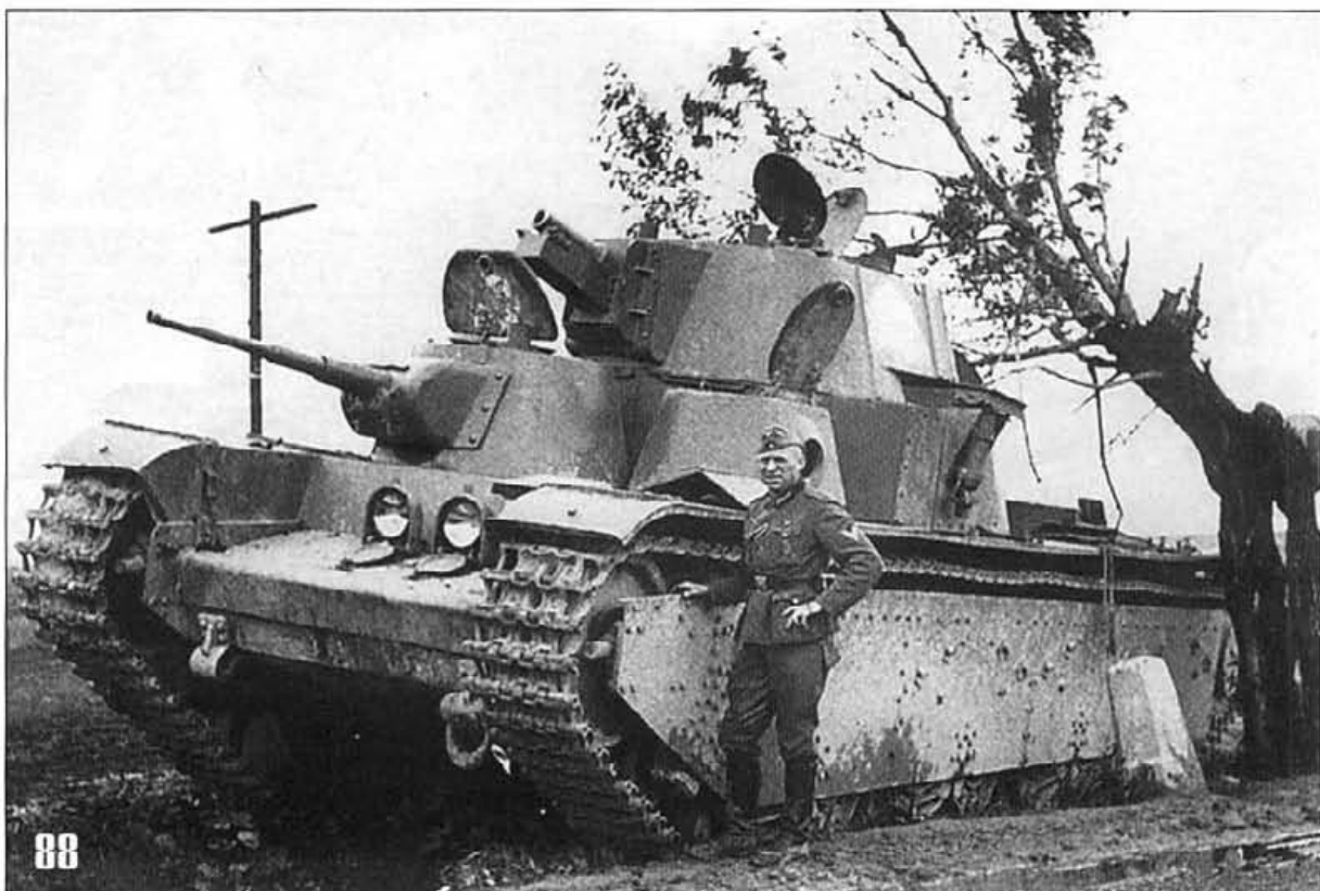
86—88. Брошенный Т-35 с коническими башнями. Июль 1941 года. Танк выпуска февраля — апреля 1939 года с прямой подбашенной коробкой. Белый треугольник на башне — тактический знак 68-го танкового полка (БА).
