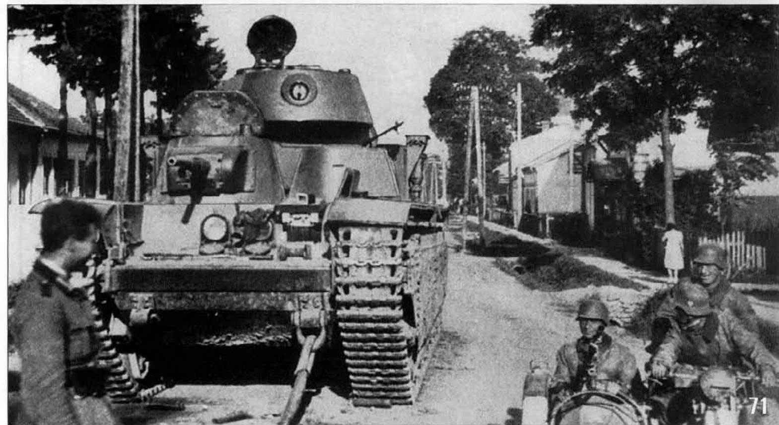
71—74. Т-35 выпуска февраля — апреля 1939 года, брошенный экипажем из-за неисправностей. Июль 1941 года. Машина имеет двустворчатый люк механика-водителя, открывающийся в одну сторону и пулеметную установку в нише главной башни. На фото 74, сделанном в сентябре 1941 года, машина сдвинута в сторону с дороги и уже не имеет гусениц (АСКМ).
