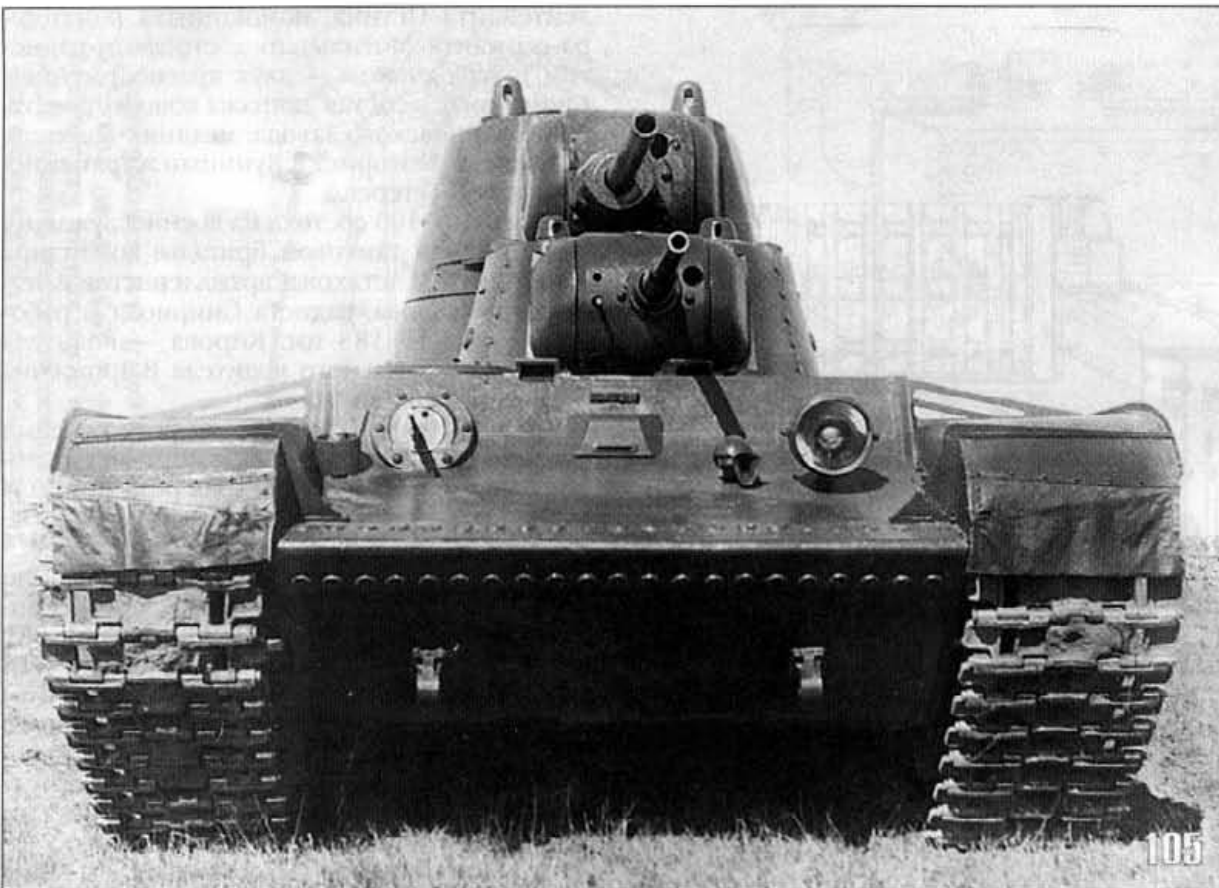
105. Танк СМК на полигонных испытаниях. Август 1939 года. Хорошо видна форма траков, установка курсового пулемета, фара и звуковой сигнал (АСКМ).
