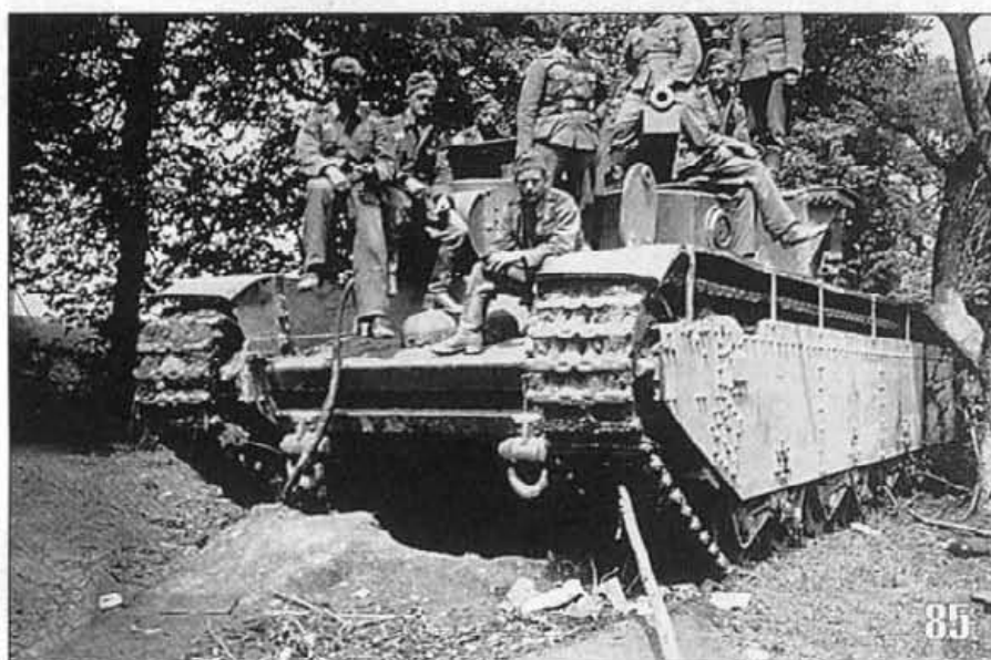
84. Немецкий солдат фотографируется на фоне Т-35. Район Львова, октябрь 1941 года. Танк выпуска 1938 года с дополнительным бронированием шаровых установок малых башен (БА).
