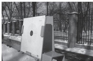
**Рис. 3. Пулеулавливатель и рамка с мишенью, установленные на стойке СМПУ-3**
