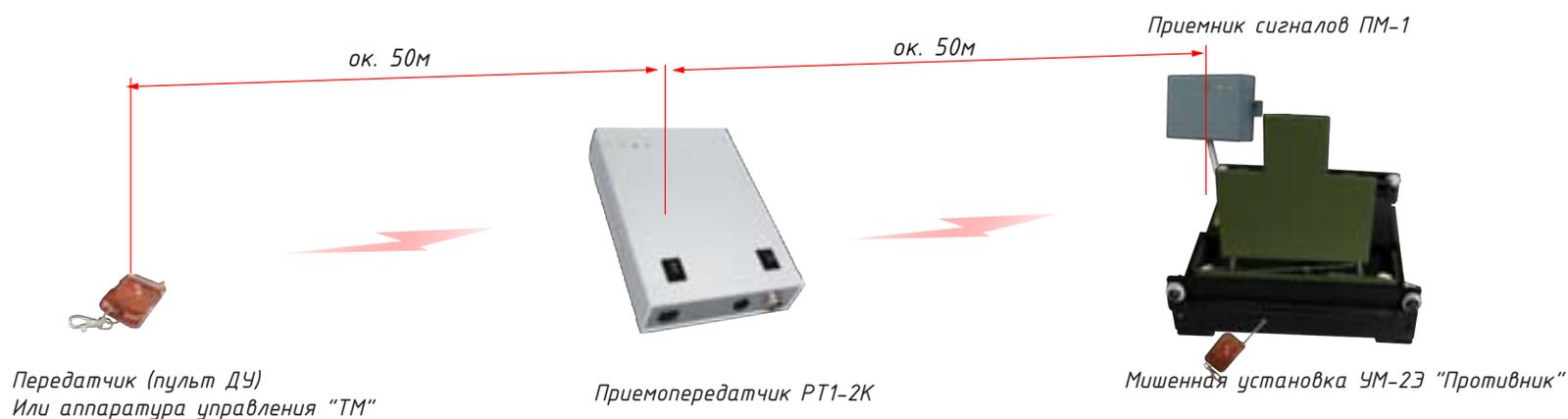
Несколько мишенных установок УМ-2Э «Противник» можно объединять в группу и использовать при этом один источник питания и единую систему управления. Подъем и опускание мишеней всех установок в группе будет происходить синхронно от пульта дистанционного управления одной из установок или аппаратуры управления «Т-Медиа».
